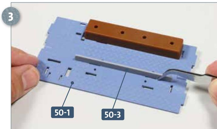
Geben Sie etwas Sekundenkleber auf die beiden Zapfen der Längsstütze **50-3** und fügen Sie diese in die Schlitzte des Bodens **50-1** ein, wie abgebildet.
