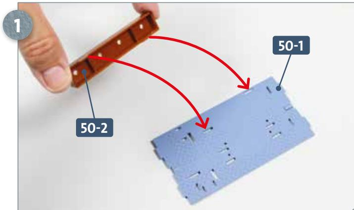
Legen Sie den Boden **50-1** auf Ihre Arbeitsplatte, ausgerichtet wie abgebildet. Nehmen Sie den Kojenkasten **50-2**, versehen Sie dessen zwei Zapfen mit etwas Sekundenkleber und fügen Sie diese in die Schlitzte der Bodenplatte ein, wie es die Pfeile andeuten.
