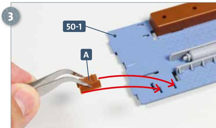
Geben Sie etwas Sekundenkleber auf die beiden Zapfen an der Unterseite des Teils A und fügen Sie diese in die Schlitzte des Bodens 50-1 ein, auf die die Pfeile weisen.
