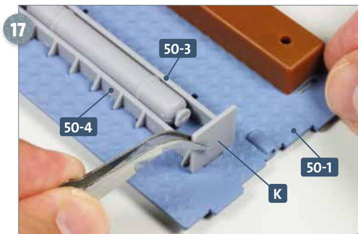
17 Versehen Sie den breiten Zapfen des Teils K mit etwas Sekundenkleber und fügen Sie diesen in den Schlitz des Bodens 50-1 ein, der sich neben den Längsstützen 50-3 und 50-4 befindet.
