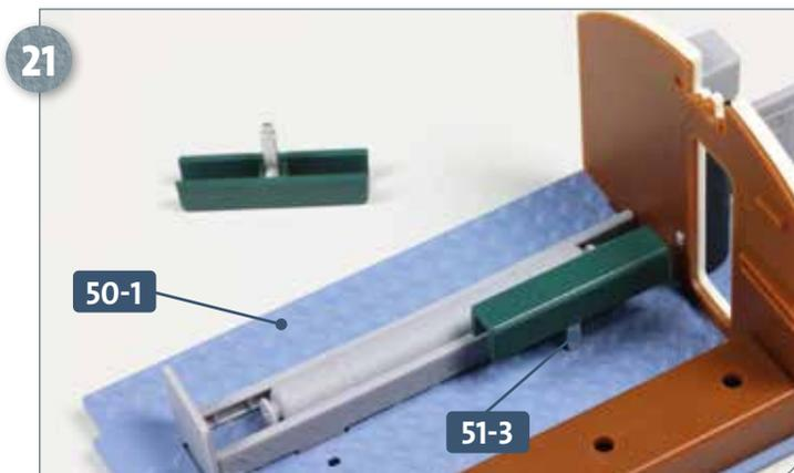
21 Geben Sie etwas Sekundenkleber auf den Zapfen an der Unterseite vom Ständer **51-3** der ersten Back und fügen Sie diesen in den Schlitz des Bodens **50-1** ein, wie abgebildet.
