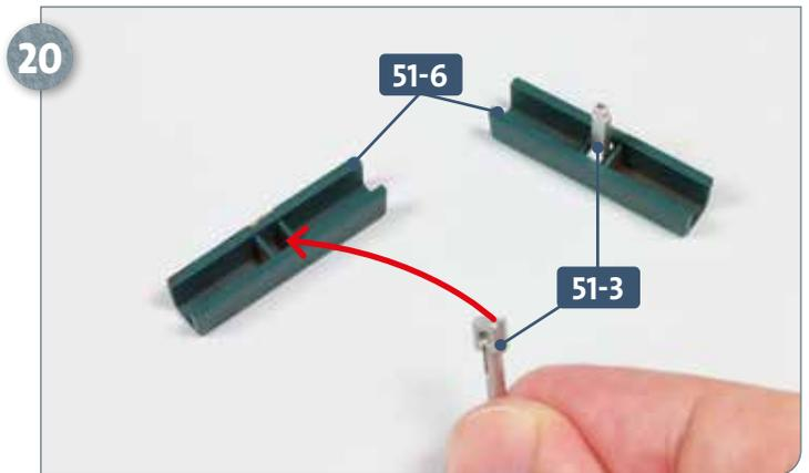
20 Trennen Sie die zwei Backen aus dem Rahmen **51-6** und die beiden Ständer aus dem Rahmen **51-3**. Versehen Sie die Oberseiten der Ständer mit etwas Klebstoff und fixieren Sie sie an der Unterseite der Backen, wie abgebildet bzw. angedeutet.
