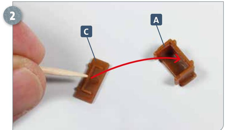
Versehen Sie den Rand des Vorsprungs an der Innenseite von Teil C mit etwas Sekundenkleber und fixieren Sie ihn an Teil A, wie es der Pfeil andeutet.
