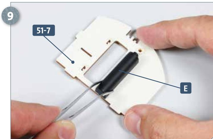
Versehen Sie die zwei Zapfen an der Rückseite von Teil **E** mit Sekundenkleber und fixieren Sie sie in den Aufnahmen der Trennwand **51-7**, wie abgebildet.
