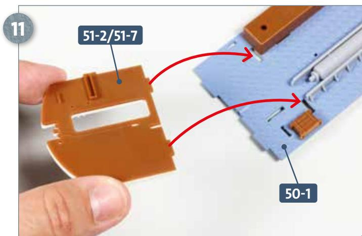
Versehen Sie die zwei Zapfen an der Unterseite der zusammengeführten Trennwand **51-2/51-7** mit etwas Sekundenkleber und führen Sie diese zu den Schlitten des Bodens **50-1**, auf die die Pfeile weisen.
