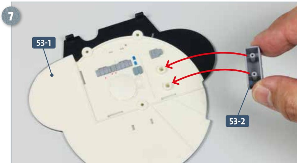
Nehmen Sie den Kühlschrank **53-2** und versehen Sie die Zapfen an seiner Rückseite mit etwas Sekundenkleber. Führen Sie die Rückseite zu den beiden Aufnahmen am Schott **53-1**, auf die die Pfeile weisen.
