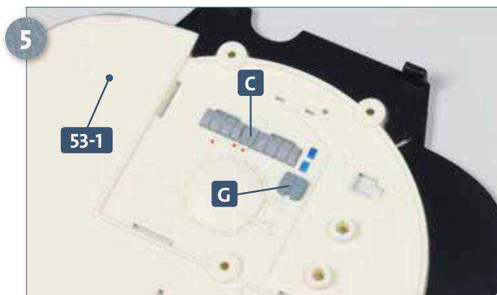
Das Teil **C** ist am Schott **53-1** angebracht. Schräg unterhalb von **C** wird das Teil **G** festgeklebt, wie abgebildet.
