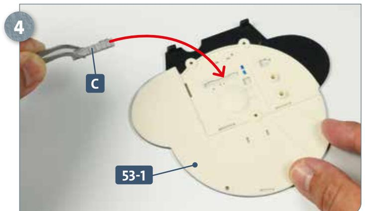
Nehmen Sie das Teil **C**, versehen Sie dessen unteren Rand mit etwas Sekundenkleber und fügen Sie das Teil in die längliche Aussparung des Schotts **53-1** ein, wie es der Pfeil andeutet.
