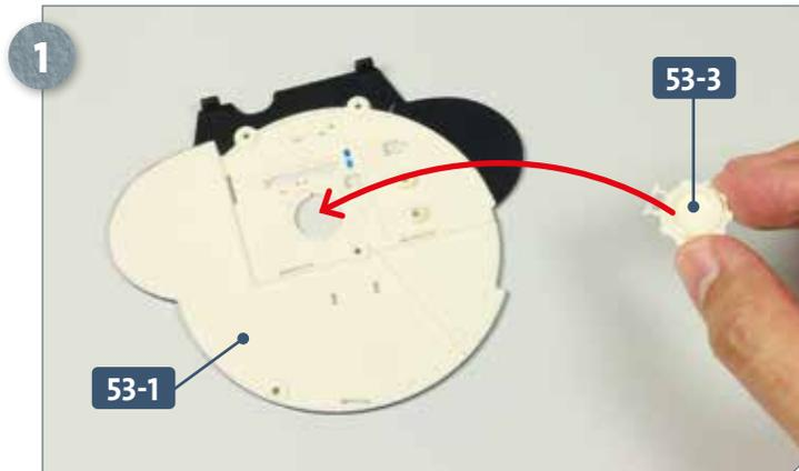
Legen Sie das vordere Schott der vierten Sektion **53-1** auf Ihre Arbeitsplatte. Nehmen Sie das Kugelschott **53-3**, versehen Sie dessen Innenseite mit etwas Sekundenkleber und fügen Sie ihn in die zentrale Öffnung des Schotts **53-1**, wie es der Pfeil andeutet.
