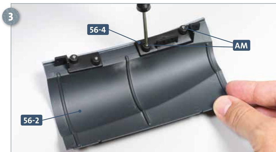
Setzen Sie den Verbinder **56-4** am Rumpfabschnitt **56-2** auf und befestigen Sie ihn mit den beiden verbliebenen Schrauben **AM**, wie es das Foto zeigt.
