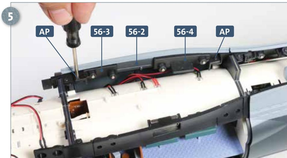
Befestigen Sie den Rumpfabschnitt **56-2** an der Rumpfstruktur, indem Sie in die Löcher der beiden Verbinder **56-3** und **56-4** jeweils eine Schraube **AP** eindrehen.
