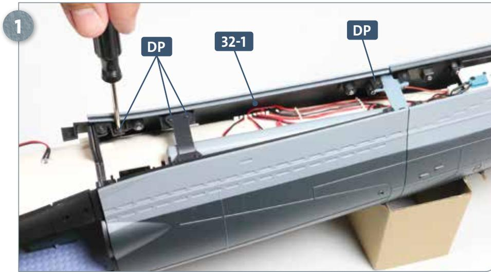
Stellen Sie die Rumpfstruktur auf Ihre Arbeitsplatte. Zunächst wird der Rumpfabschnitt **32-1** wieder demontiert, da sich bei seiner Farbgebung ein kleiner Fehler eingeschlichen hat. Lösen Sie dazu die vier Schrauben **DP**, die im Foto markiert sind.
