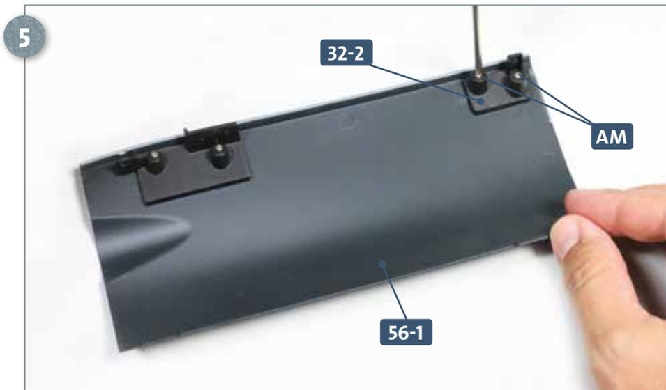
Am anderen Ende vom Rumpfabschnitt **56-1** setzen Sie den Verbinder **32-2** auf. Befestigen Sie ihn ebenfalls mit zwei Schrauben **AM**.
