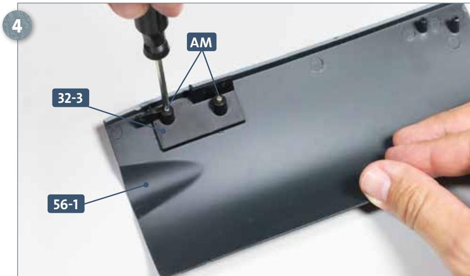
Nun legen Sie den Rumpfabschnitt **56-1** mit der Außenseite nach unten auf Ihre Arbeitsplatte. (Er unterscheidet sich durch einen etwas anderen Verlauf der beiden Grautöne vom Rumpfabschnitt **32-1**.) Setzen Sie den Verbinder **32-3** auf den Rumpfabschnitt und fixieren Sie ihn mit zwei Schrauben **AM**.
