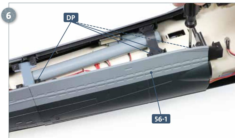
Setzen Sie den Rumpfabschnitt **56-1** auf der Backbordseite der Rumpfstruktur ein und befestigen Sie ihn mit den vier Schrauben **DP**, die Sie im ersten Bauschritt entfernt haben.
