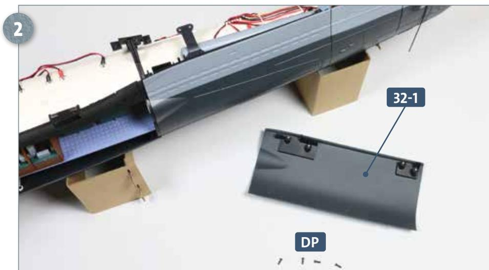
Sobald Sie die vier Schrauben **DP** gelöst haben, entfernen Sie den linken Rumpfabschnitt **32-1** vom Rumpf, wie abgebildet. Bewahren Sie die Schrauben **DP** auf, sie werden gleich noch benötigt.
