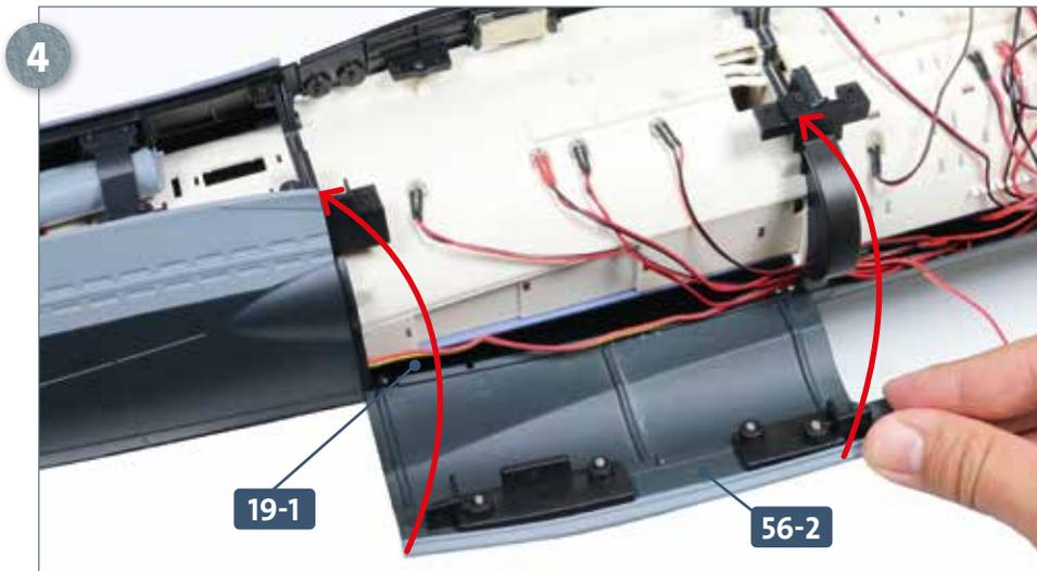
Nehmen Sie den Rumpfabschnitt **56-2** und fügen Sie seine Unterkante an der Oberkante des unteren Rumpfabschnitts **19-1** ein. Anschließend wird der Rumpfabschnitt nach oben geklappt, wie es die beiden Pfeile andeuten.
