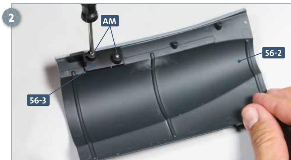
Fixieren Sie den Verbinder **56-3** mit zwei der Schrauben **AM** am Rumpfabschnitt **56-2**, wie abgebildet.
