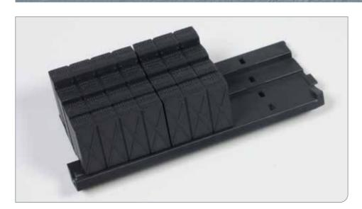
An der Installationsschiene des achteren Akkuraums sind vier weitere Batteriezellen fixiert.
