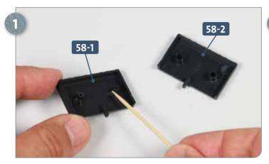
Legen Sie je eine Batteriezellenhälfte **58-1** und **58-2** auf Ihre Arbeitsplatte, mit den Innenseiten nach oben. Versehen Sie die Zapfen von Teil **58-1** mit etwas Sekundenkleber, wie angedeutet.
