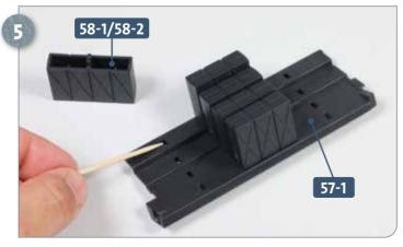
Legen Sie eine Batteriezelle **58-1/58-2** sowie die Installationsschiene **57-1** bereit und richten Sie sie aus, wie abgebildet. Versehen Sie den Schlitz, auf den der Zahnstocher weist, mit etwas Sekundenkleber.
