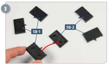
Legen Sie drei Paare mit je einer Batteriezellenhälfte **58-1** und **58-2** bereit. Versehen Sie die Zapfen von **58-1** mit Sekundenkleber und fügen Sie diese in die Aufnahmen von **58-2** ein, wie es der Pfeil für ein Teilepaar exemplarisch andeutet.
