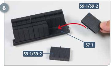
Die zweite Batteriezelle **59-1/59-2** wird im benachbarten Schlitz der Installationsschiene **57-1** festgeklebt. Versehen Sie den Zapfen der dritten Batteriezelle **59-1/59-2** mit etwas Sekundenkleber und fügen Sie ihn in den Schlitz der Schiene ein, auf den der Pfeil weist.
