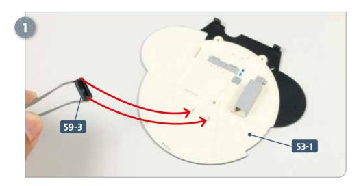
Legen Sie das vordere Schott der vierten Sektion 53-1 auf Ihre Arbeitsplatte. Nehmen Sie das Anbauteil 59-3, versehen Sie dessen zwei Zapfen mit etwas Sekundenkleber und fügen Sie diese in die Schlitze des Schotts ein, auf die die beiden Pfeile weisen.
