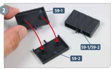
Die erste Batteriezelle **59-1/59-2** ist fertiggestellt. Legen Sie zwei weitere Teile **59-1** und **59-2** bereit, versehen Sie die Zapfen von **59-1** mit etwas Sekundenkleber und fügen Sie sie in die Aufnahmen von **59-2** ein, wie es die Pfeile andeuten.
