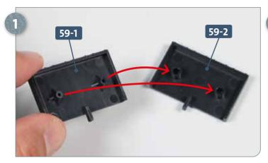
Legen Sie je eine Batteriezellenhälfte **59-1** und **59-2** bereit. Versehen Sie die Zapfen von Teil **59-1** mit etwas Sekundenkleber und fügen Sie sie in die Aufnahmen von Teil **59-2** ein, wie angedeutet.
