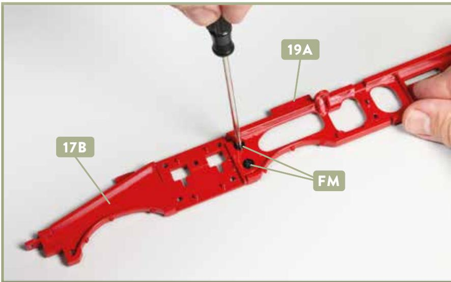
**3** Fixieren Sie die beiden Rahmenteile 17B und 19A aneinander, indem Sie die zwei Schrauben FM eindrehen.
