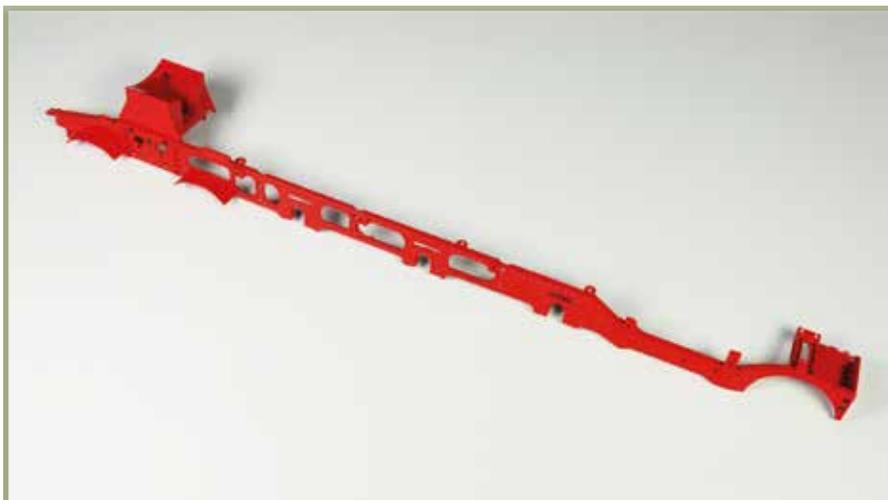
An der linken Seite des Barrenrahmens sind der vordere Rauchkammerträger und die hintere Querverbindung angebracht.
