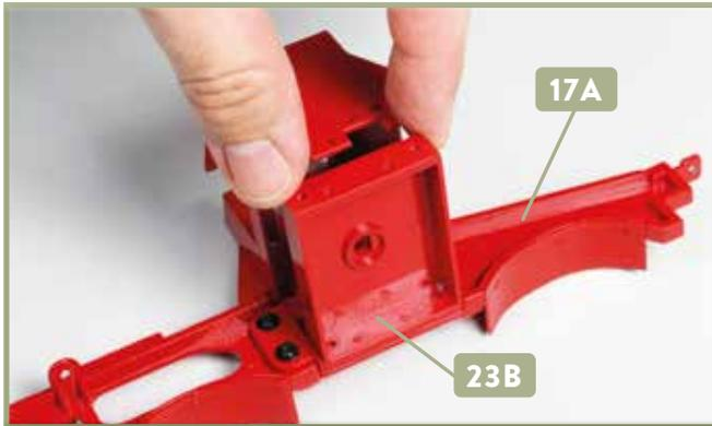
**1** Legen Sie die linke Rahmenseite so auf Ihre Arbeitsplatte, dass deren Innenseite nach oben weist. Platzieren Sie die Rahmenverbindung **23B** auf der vorderen linken Rahmenverlängerung **17A**.
