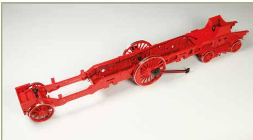
Die Abschlusspartie ist am hinteren Ende des Rahmens montiert. Der Lautsprecher ist in den Rahmen eingefügt und mit einer Abdeckung gesichert.
