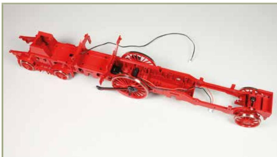
Das vordere Pendelblech und eine Abdeckung wurden am Rahmen der Lokomotive befestigt.
