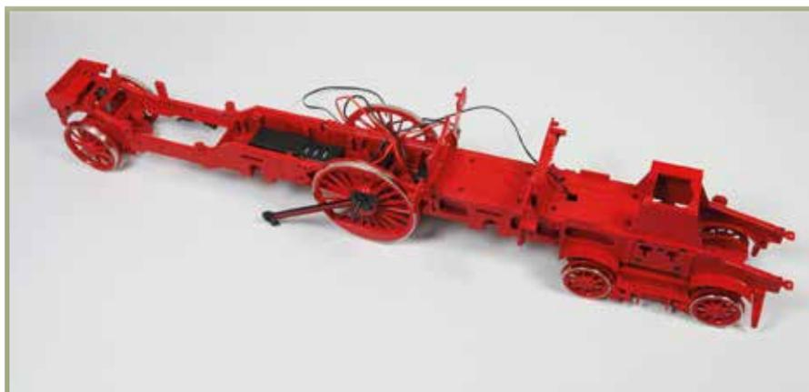
Die hintere Motor-Getriebe-Einheit ist zusammengefügt und im Rahmen montiert, der rechte Bahnräumer wurde angebracht.
