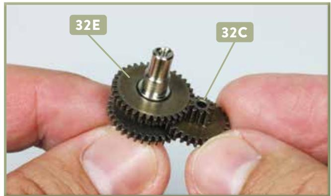
**2** Nehmen Sie das zweite Zahnrad **32C** und fügen Sie es mit dem Zahnrad mit Welle **32E** zusammen. Achten Sie dabei auf die Ausrichtung der beiden Teile.
