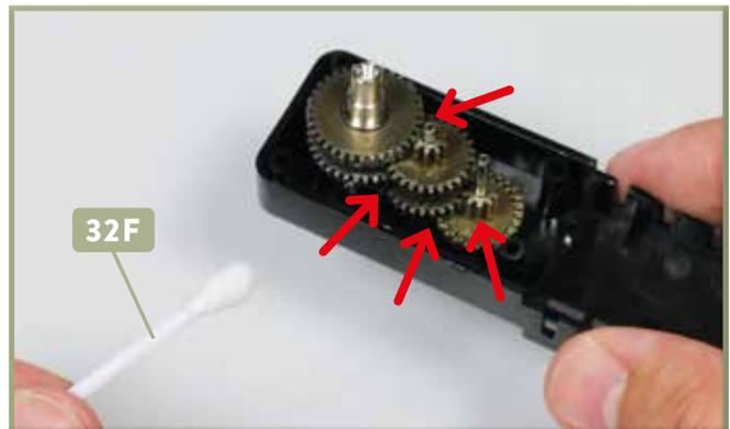
**4** Öffnen Sie das Tütchen mit Schmierfett **32G** (hier nicht abgebildet) und nehmen Sie etwas Fett mit dem Wattestäbchen **32F** auf. Verteilen Sie das Fett großzügig auf den Zähnen aller eingesetzten Zahnräder: Die Pfeile weisen auf einige der Stellen.
