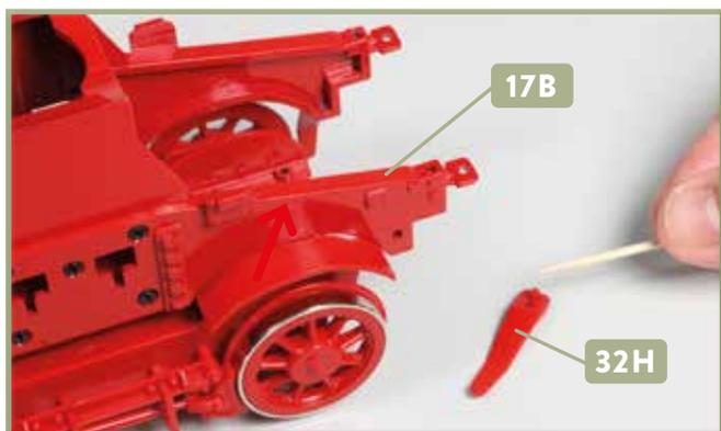
**1** Weiter geht es am vorderen Ende des Rahmens, genauer gesagt an der rechten vorderen Rahmenverlängerung **17B**. Legen Sie den rechten Bahnräumer **32H** bereit und versehen Sie dessen Zapfen mit etwas Sekundenkleber.
