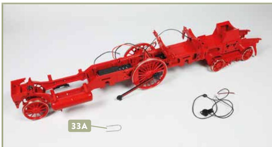
Der rechte Hauptluftbehälter ist am Fahrgestell angebracht. Die vordere linke Loklaterne ist zusammengebaut und getestet. Der Haltebügel **33A** wird erst mit der nächsten Bauanleitung benötigt.
