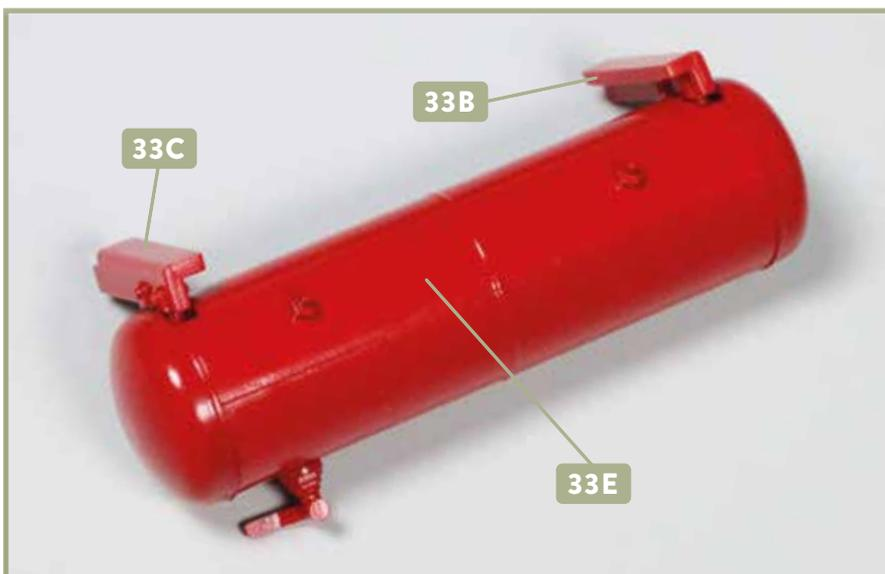
**6** Am anderen Ende vom Oberteil des Hauptluftbehälters **33E** wird der linke Träger **33B** festgeklebt. Achten Sie dabei unbedingt auf die Ausrichtung der beiden Träger, wie abgebildet.
