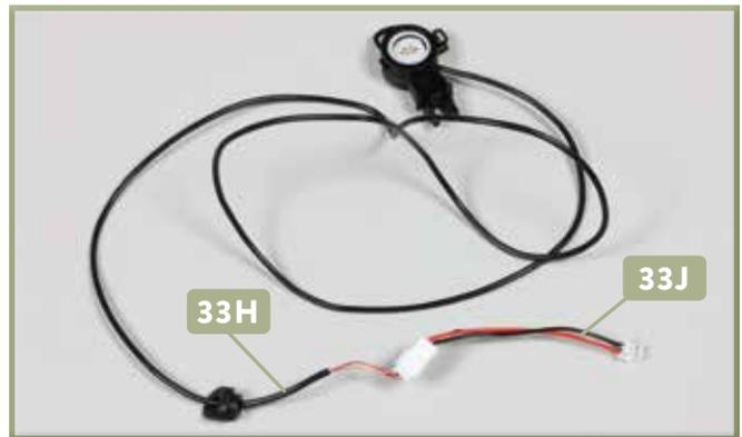
**4** Legen Sie das Verbindungskabel **33J** bereit. Fügen Sie den Stecker von **33H** in die Buchse von **33J** ein, wie abgebildet.
