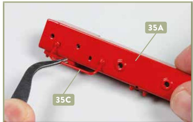
**2** Versehen Sie die beiden Enden der ersten Griffstange 35C mit etwas Sekundenkleber und fügen Sie sie in die Bohrungen an der Unterseite des Pufferträgers 35A ein.
