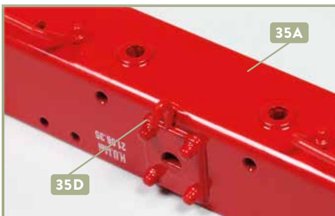
**5** Die Halterung 35D wird in der zentralen, kleinen Bohrung an der Vorderseite des Pufferträgers 35A fixiert: Achten Sie dabei auf die Ausrichtung der Halterung.
