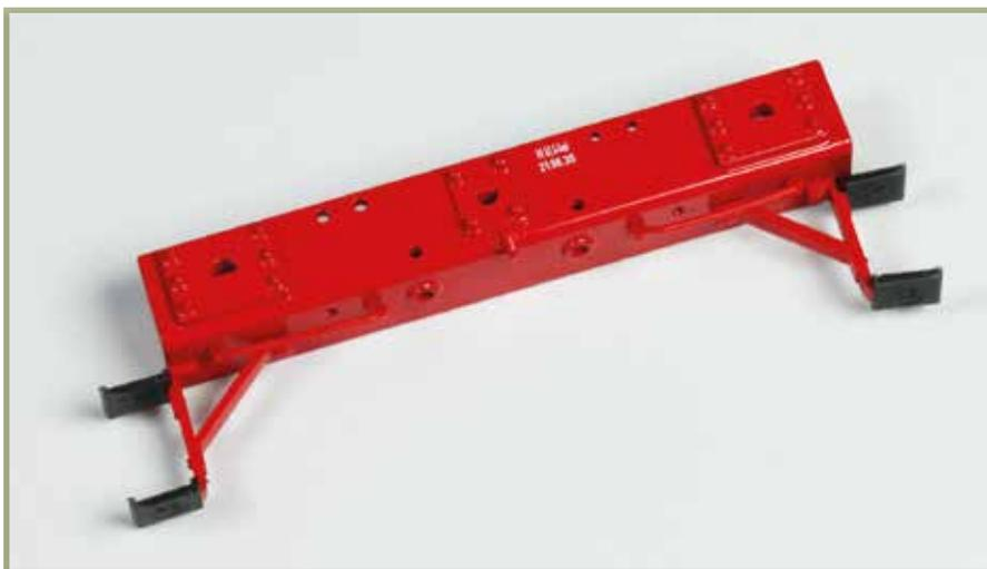
Die Arbeiten am Pufferträger haben begonnen: zwei Griffstangen, die beiden Rangiertritte und eine Halterung sind montiert.
