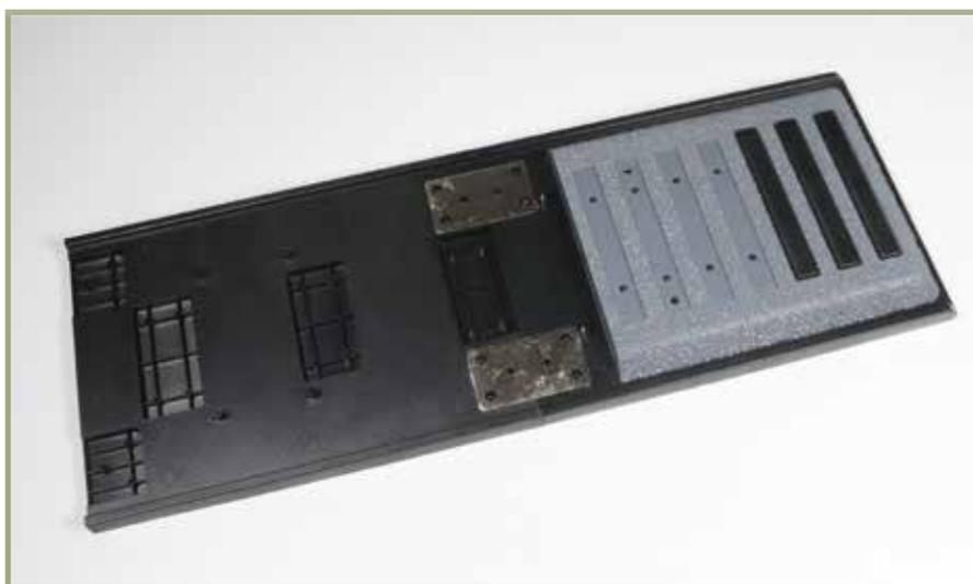
Der erste Abschnitt der Bettung wurde mit der Bodenplatte verschraubt. Die drei ersten Schwellen sind auf der Bettung angebracht.
