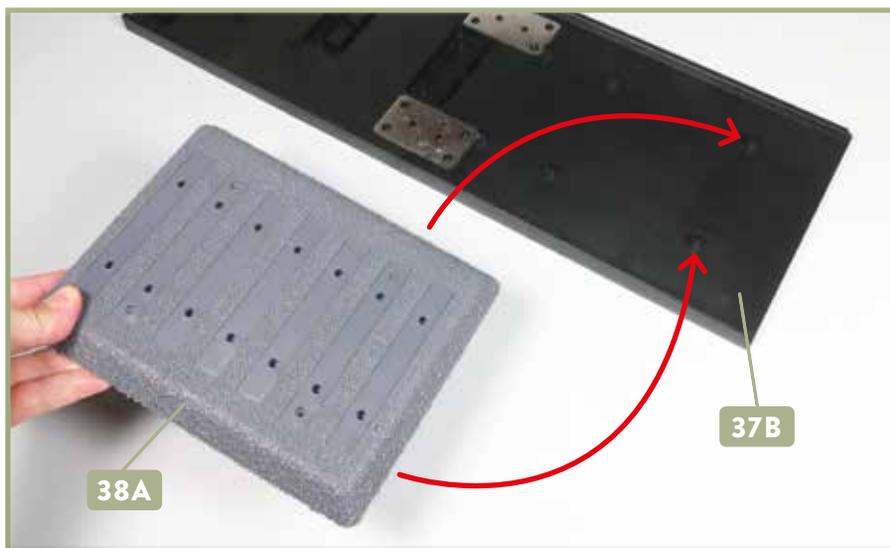
**1** Legen Sie die in der letzten Ausgabe gefertigte Bodenplatte des Gleisbetts auf Ihre Arbeitsplatte. Nehmen Sie die erste Bettung **38A** und führen Sie sie zu den Aufnahmen des Bodenteils **37B**, wie es die Pfeile andeuten.
