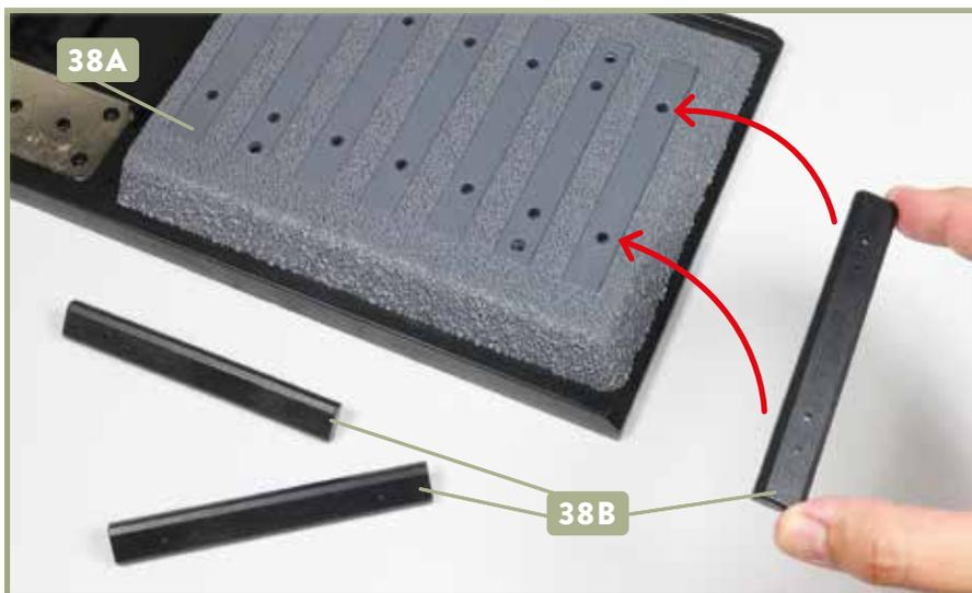
**4** Legen Sie die drei Schwellen **38B** bereit. Führen Sie die erste von ihnen zu den beiden Aufnahmen in der Bettung **38A**, auf die die Pfeile weisen. Es handelt sich um eine Steckverbindung: Die beiden Zapfen der Schwellen werden einfach in die entsprechenden Aufnahmen der Bettung hineingedrückt.
