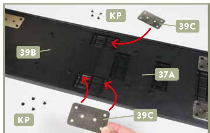
**6** Setzen Sie je einen Verbinder **39C** auf die zwei Fügebereiche der beiden Bodenteile **37A** und **39B**, wie es die Pfeile andeuten. Legen Sie acht Schrauben **KP** bereit.
