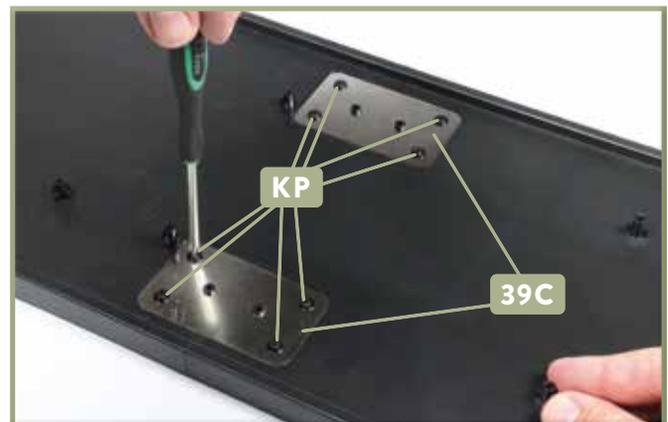
**4** Fixieren Sie die beiden Verbinder **39C**, indem Sie in ihre vier äußeren Bohrungen je eine Schraube **KP** eindrehen, wie abgebildet.
