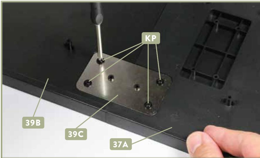
**7** Fixieren Sie den unteren Verbinder **39C** mit vier Schrauben **KP** an den beiden Bodenteilen **37A** und **39B**.
