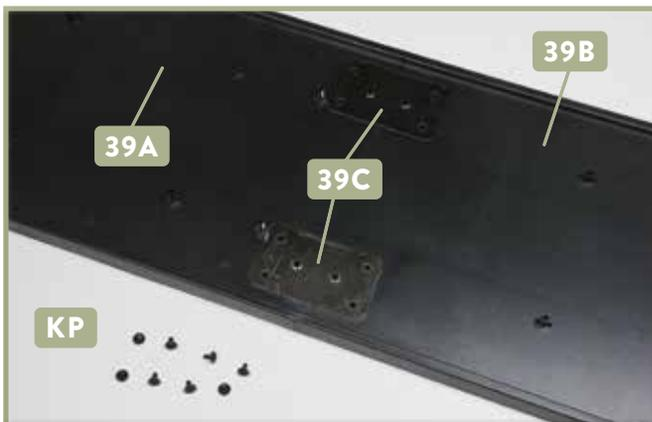
**3** Die beiden Verbinder **39C** sind auf den beiden Bodenteilen **39A** und **39B** platziert: Ihre je sechs Bohrungen nehmen die sechs Zapfen der Bodenteile auf. Legen Sie acht Schrauben **KP** bereit.
