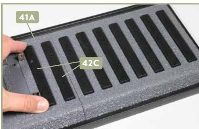
**5** Drücken Sie die erste Schwelle **42C** in die entsprechenden Aufnahmen der Bettung **41A** hinein. Wiederholen Sie den Vorgang mit der zweiten Schwelle **42C**, wie abgebildet.
