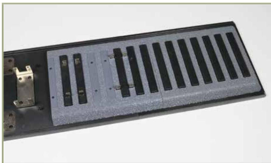
An der Bodenplatte ist die dritte Schienenrollen-Halterung angebracht. In der Bettung sind fünf weitere Schwellen montiert.
