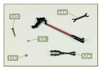
Nehmen Sie die Steuerungs-Baugruppe aus Ausgabe 52 zur Hand und lösen Sie mithilfe der beiden Schraubenschlüssel 44H den Schraubbolzen 52O, die Mutter 52L und die Unterlegscheibe 52N. Nehmen Sie den Voreilhebel 52M ab.
