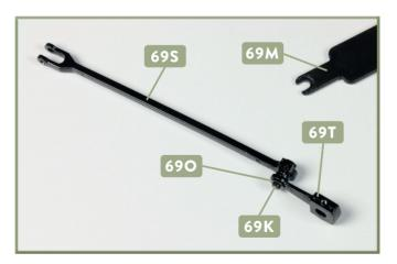
15 Platzieren Sie die Bohrung der Gegenkurbel 69T vor der Bohrung der Schwingenstange 69S. Fügen Sie von hinten den Schraubbolzen 69K ein und sichern Sie diesen mit einem C-Ring 69O, den Sie mithilfe des Aufsteckschlüssels 69M anbringen.
