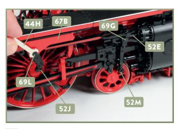
12 Führen Sie den Schraubbolzen 69G durch die Bohrungen von Voreilhebel 52M und Schieberstange 52E und drehen Sie ihn mithilfe des Schraubenschlüssels 44H fest. Der Schraubbolzen 69L sichert die Schwinge 52J am Schwingenträger 67B.
