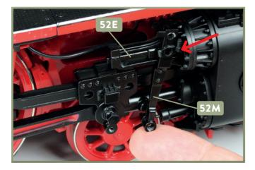
9 Fügen Sie den Voreilhebel 52M so von unten neben der Zylinderblock-Baugruppe ein, dass seine zweitoberste Bohrung mit der Bohrung der Schieberstange 52E fluchtet (Pfeil).
