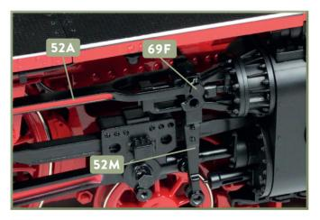
10 Die Baugruppe mit der Schieberschubstange 52A wird so herangeführt, dass ihre Bohrungen mit den obersten Bohrungen des Voreilhebels 52M fluchten. Sichern Sie die Bauteile aneinander, indem Sie von außen den Schraubbolzen 69F einsetzen.
