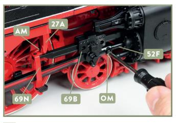
7 Fixieren Sie das obere Ende des Fangbügels 69N mit einer Schraube AM an der Rauchkammerstütze 27A. Schieben Sie das zylindrische Ende des Kreuzkopfes 69B über das hintere Ende der Kolbenstange 52F und drehen Sie eine Schraube OM ein.
