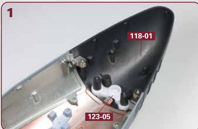
Positionieren Sie die Getriebehalterung **123-05** so an der Rumpfstruktur, dass ihre beiden Öffnungen die Zapfen vom Heck **118-01** aufnehmen, wie es das Foto zeigt.
