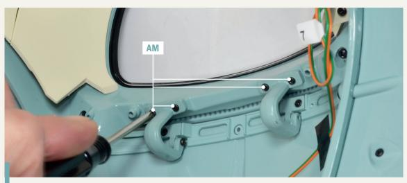
70-14. Befestigen Sie den Deckel an der Karosserie, indem Sie vier Schrauben AM in den dafür vorgesehenen Löchern in den Scharnieren anziehen.
