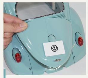
**70-13.** Nehmen Sie die Karosserie Ihres Modells zur Hand und positionieren Sie den hinteren Deckel in seinem Gehäuse, indem Sie die beiden Scharniere durch die Öffnung im Motorraum führen.
