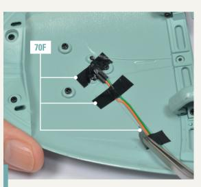
70-12. Schieben Sie den Kabelbaum entlang der Rille auf der Innenseite des Deckels nach hinten. Verwenden Sie drei Abschnitte des Klebestreifens 70F, um ihn zu fixieren.
