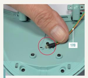
**70-11.** Stecken Sie die LED von Segment 17B des Kabelbaums 7 von der Innenseite des Deckels in das zentrale Loch der Kennzeichenleuchte. Biegen Sie die Kabel wie gezeigt und achten Sie darauf, dass sie nicht beschädigt werden.
