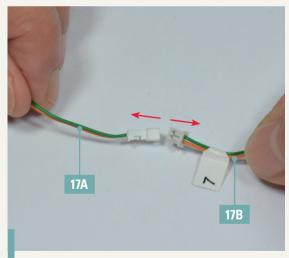
**70-10.** Nehmen Sie die Komponenten des elektrischen Systems zur Hand und trennen Sie die beiden Segmente des Kabelbaums 7 (17A und 17B). Achten Sie darauf, dass Kabel und Stecker nicht beschädigt werden.
