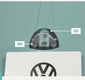
**70-6.** Setzen Sie die Dichtung 70E und die Scheibe 70D wie abgebildet an der Außenseite des Deckels ein.
