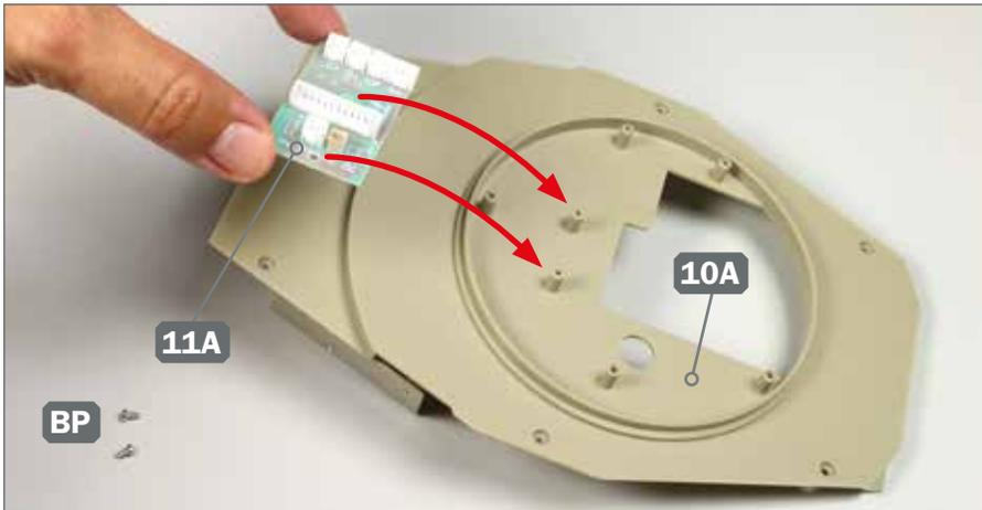
**1** ▶ Drehen Sie die Bodenplatte des Turms 10A um und legen Sie zwei Schrauben BP bereit. Nehmen Sie die Platine 11A und führen Sie deren Aussparungen zu den beiden zentralen Zapfen an der Bodenplatte, wie es die Pfeile andeuten.
