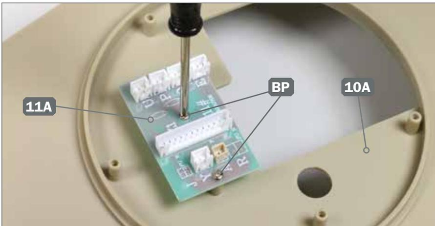
**2** ▶ Fixieren Sie die Platine 11A mit den beiden Schrauben BP an der Bodenplatte 10A.
