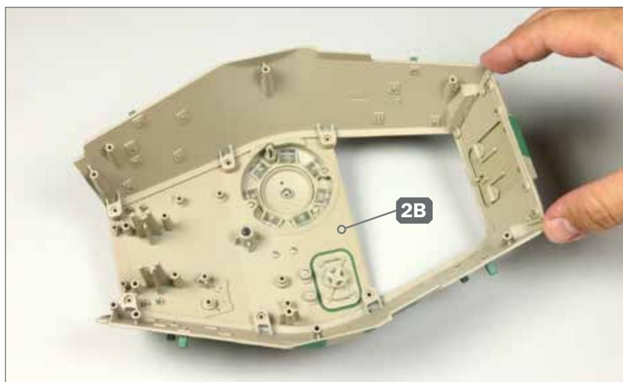
**4** ▶ Setzen Sie die Turmwand-Baugruppe auf das Turmdach 2B: Die sechs Zapfen des Dachs sind in die Aufnahmen der beiden seitlichen Turmwände eingefügt.
