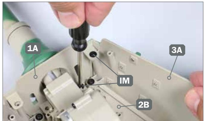
**4** ▶ Befestigen Sie die Stirnplatte 1A mit jeweils einer Schraube IM am Turmdach 2B und an der linken Turmwand 3A, wie abgebildet.
