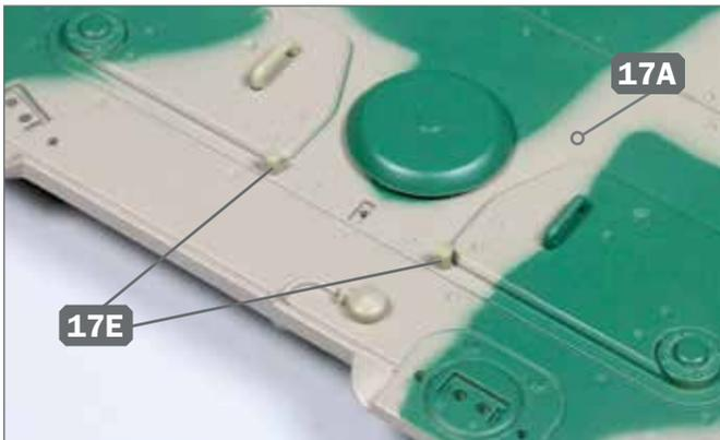
**9** ▶ Die beiden Stifte 17E werden in den kleinen Bohrungen unmittelbar vor der Funker- bzw. Fahrerluke an der Panzerwanne 17A festgeklebt, wie es das Foto zeigt.
