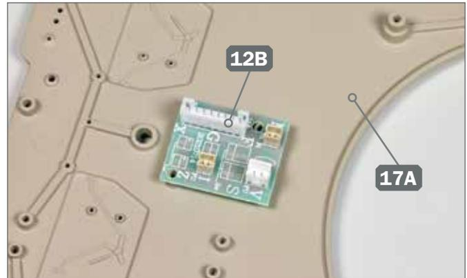
**2** ▶ Die Platine 12B ist korrekt auf der Unterseite vom Oberteil der Panzerwanne 17A aufgesetzt.
