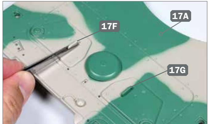
**8** ▶ Als Nächstes werden die beiden Griffe 17F und 17G auf der Panzerwanne 17A festgeklebt, und zwar in den Bohrungen der Funker- bzw. Fahrerluke.
