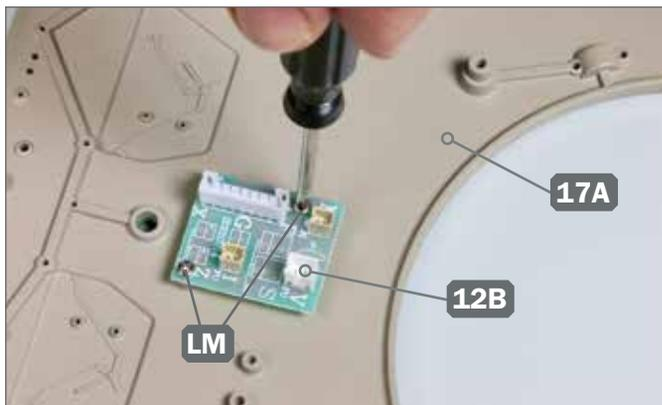
**3** ▶ Befestigen Sie die Platine 12B mit zwei Schrauben LM am Oberteil der Panzerwanne 17A.
