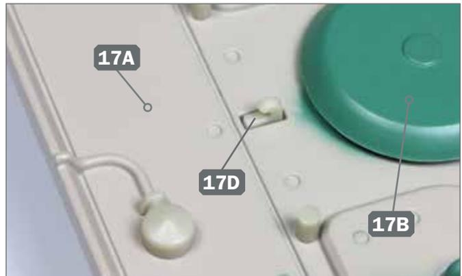
**10** ▶ Zuletzt wird der Haken 17D, ausgerichtet wie abgebildet, vor der Belüftungsabdeckung 17B auf der Panzerwanne 17A festgeklebt.
