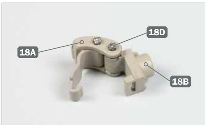
**5** ► Positionieren Sie den Halterungsfuß 18B so, dass seine Bohrung sich zwischen den Armen des Bügels 18A befindet. Befestigen Sie beide Teile mit dem Scharnierstift 18D aneinander, wie abgebildet.
