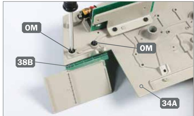
**4** ▶ Halten Sie das Scharnier 38B in Position, während Sie die Baugruppe umdrehen. Fixieren Sie das Scharnier mit zwei Schrauben OM an der Rückwand 34A.
