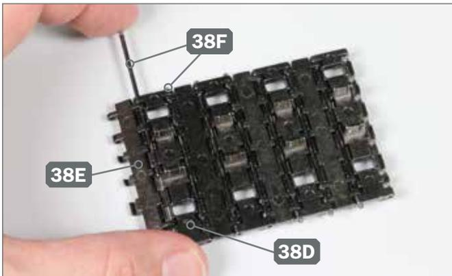
**5** ▶ Mit den verbliebenen Kettengliedern 38D und 38E, die Sie mit je einem Verbindungsstift 38F sichern, komplettieren Sie den Kettenabschnitt.
