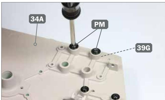
**5 ▶** Halten Sie den C-Haken 39G in Position, drehen Sie die Baugruppe um und fixieren Sie den Haken an der Rückwand 34A, indem Sie die zwei Schrauben PM eindrehen, wie abgebildet.
