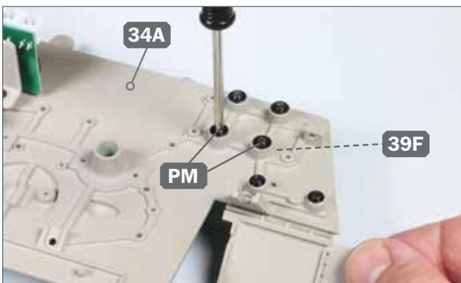
**5 ▶** Halten Sie den C-Haken 39F in Position, drehen Sie die Baugruppe um und befestigen Sie den Haken mit den zwei Schrauben PM an der Rückwand 34A.
