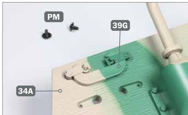
**4 ▶** Sitzen die Zapfen der Aufnahmen in den Bohrungen der Rückwand, liegt der C-Haken 39G plan auf der Rückwand 34A auf. Legen Sie zwei Schrauben PM bereit.
