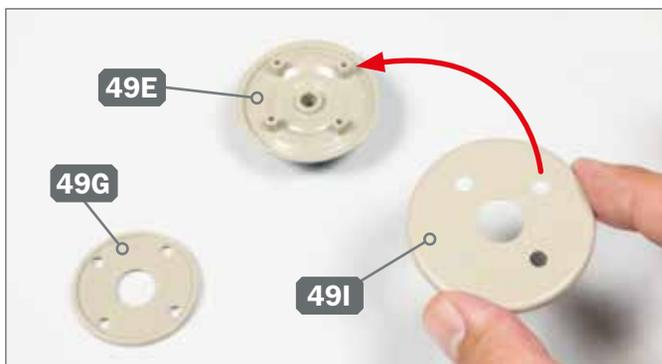
**1** ▶ Legen Sie die Lochscheibe 49G und das äußere Laufrad 49E auf Ihre Arbeitsplatte. Nehmen Sie die Lochscheibe 49I und platzieren Sie sie auf der Innenseite des Laufrads, wie angedeutet.
