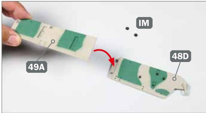
**1** ▶ Legen Sie das Wannenseitenteil 48D und zwei Schrauben IM auf Ihre Arbeitsplatte. Führen Sie das Wannenseitenteil 49A zum vorderen Ende des Wannenseitenteils 48D, wie angedeutet.
