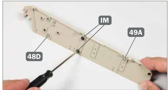
**2** ▶ Fixieren Sie die beiden Wannenseitenteile 48D und 49A aneinander, indem Sie an deren Innenseiten die zwei Schrauben IM eindrehen.
