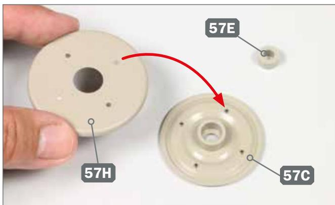
**3** ► Legen Sie die Manschette 57E und das innere Laufrad 57C bereit. Nehmen Sie die Lochscheibe 57H und setzen Sie sie auf das Laufrad.
