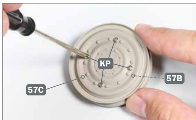
**6** ► Fixieren Sie die beiden Laufrad-Baugruppen 57B und 57C aneinander, indem Sie die vier Schrauben KP an der Außenseite des inneren Laufrads eindrehen.
