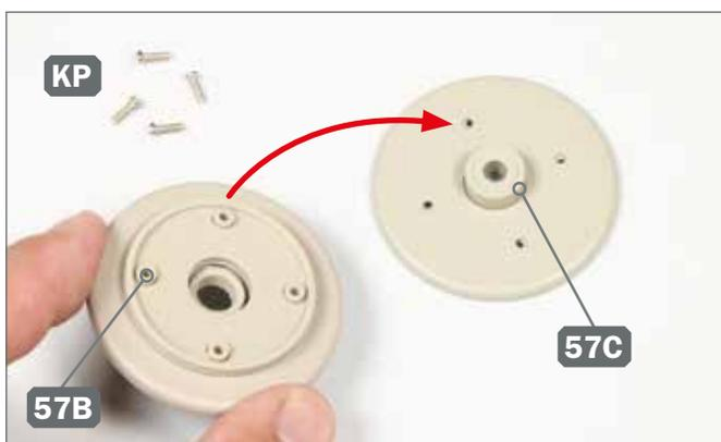
**5** ► Fügen Sie die beiden Laufrad-Baugruppen 57B und 57C zusammen, wie es der Pfeil andeutet. Legen Sie vier Schrauben KP bereit.
