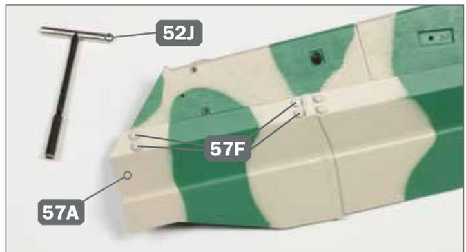
**2** ▶ Befestigen Sie den Kettenschutz 57A mit den vier dunkelgelben Schrauben 57F an der Seitenwand. Verwenden Sie dazu den Sechskant-Steckschlüssel 52J.
