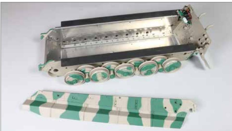
▶ Das letzte Doppellaufwerk wurde an der linken Seite der Panzerwanne montiert. Der letzte Abschnitt vom linken Kettenschutz ist an der linken Seitenwand befestigt.
