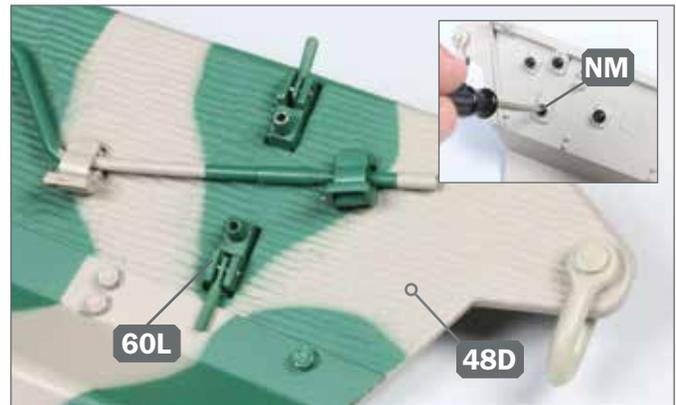
**8** ▶ Platzieren Sie die Halterung 60L ebenfalls auf dem Wannenseitenteil 48D und befestigen Sie sie von innen mit einer Schraube NM (Detailbild).
