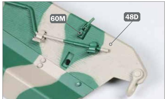
**6** ▶ Platzieren Sie die Halterung 60M auf dem hintersten Abschnitt des linken Wannenseitenteils 48D.
