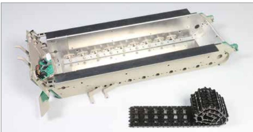
► Die zweite Laufkette besteht inzwischen aus 48 Kettengliedern. Auf der rechten Seite der Panzerwanne sind die beiden ersten Achsschenkel montiert.
