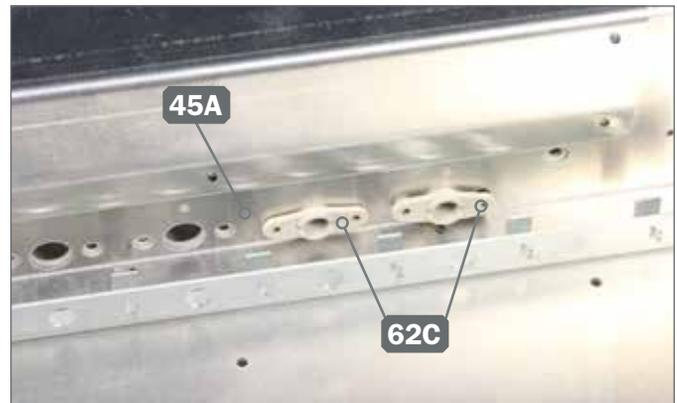
**2** ► Fügen Sie die zwei Halterungen 62C so auf der rechten Seite der Panzerwanne ein, dass ihre Bohrungen in den hintersten Öffnungen der Drehstabstütze 45A sitzen.
