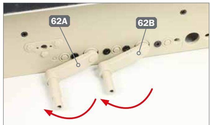
**6** ► Drehen Sie die beiden Achsschenkel 62A und 62B nach hinten, sodass sie sicher in den Halterungen sitzen, wie abgebildet.
