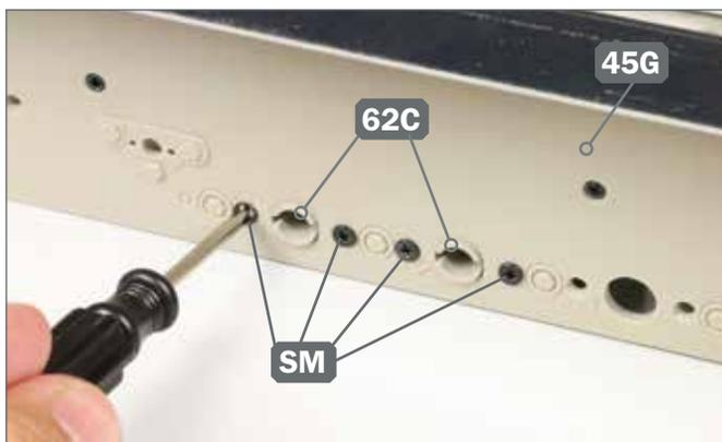
**3** ► Fixieren Sie die beiden Halterungen 62C am Seitenteil 45G, indem Sie von außen je zwei der Schrauben SM eindrehen, wie es das Foto zeigt.
