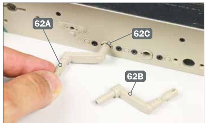
**4** ► Nehmen Sie den Achsschenkel 62A (mit eingravierter 1) und fügen Sie seinen Schaft in die Bohrung der hinteren Halterung 62C ein. Legen Sie auch den Achsschenkel 62B (mit eingravierter 2) bereit.
