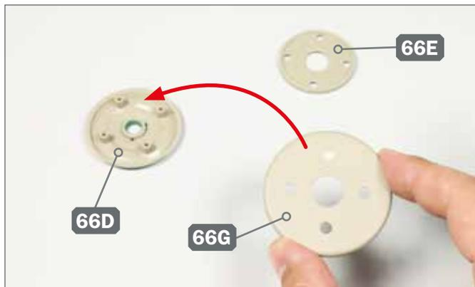
**1** ▶ Legen Sie die Lochscheibe 66E und das äußere Laufrad 66D bereit. Nehmen Sie die Lochscheibe 66G und platzieren Sie sie auf dem Laufrad, wie angedeutet.
