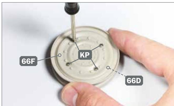
**6** ▶ Drehen Sie das Doppellauftrad vorsichtig um und bringen Sie die vier Löcher der beiden Baugruppen zum Fluchten. Ziehen Sie darin vier Schrauben KP fest.
