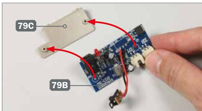
**1** ▶ Legen Sie die Ersatz-Halterung 79C auf Ihre Arbeitsplatte. Nehmen Sie die Ersatz-Platine 79B und führen Sie sie zur Halterung, wie angedeutet.
