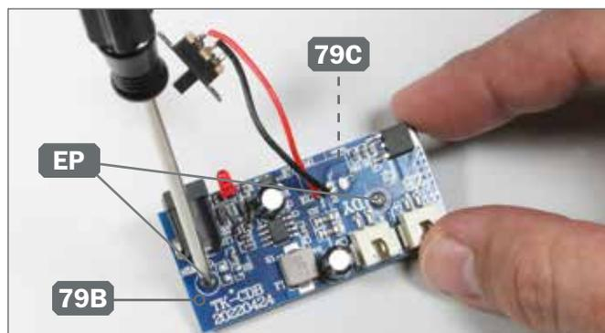
**2** ▶ Fixieren Sie die Ersatz-Platine 79B an der Ersatz-Halterung 79C, indem Sie zwei Schrauben EP in die Aufnahmen beider Teile eindrehen.
