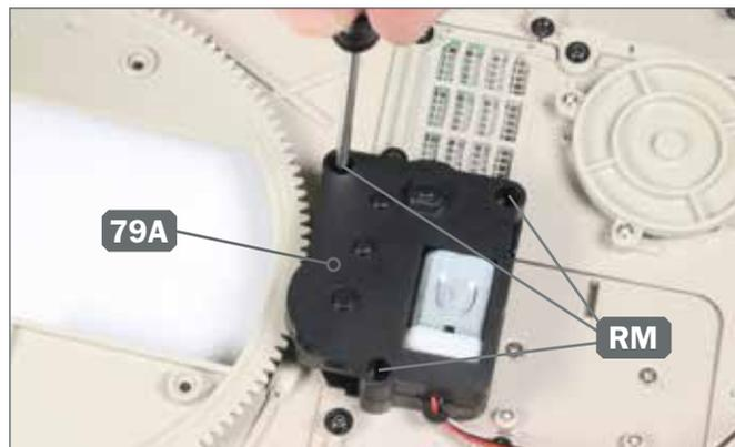
**4** ▶ Fixieren Sie das Turmdrehgetriebe 79A mit drei Schrauben RM an der Panzerwanne.
