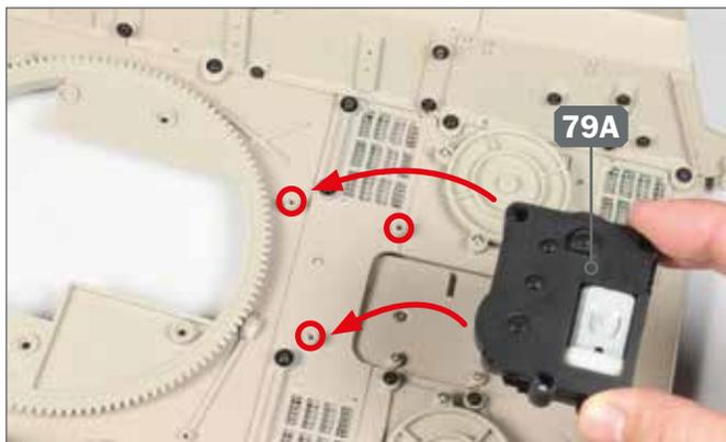
**3** ▶ Führen Sie das Turmdrehgetriebe 79A zu den drei Aufnahmen (eingekreist) an der Panzerwanne.
