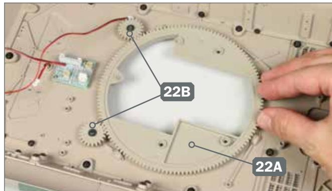
**2** ▶ Platzieren Sie den Turmdrehkranz 22A so in der Aussparung vom Oberteil der Panzerwanne, dass seine Zähne in die der beiden Zahnräder 22B greifen.
