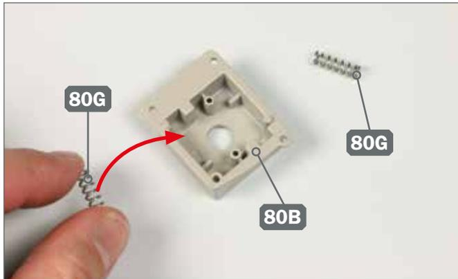
**1** ► Legen Sie die Leitradaufhängung 80B und die zwei Federn 80G auf Ihre Arbeitsplatte. Führen Sie die erste Feder zur Aufhängung, wie es der Pfeil andeutet.
