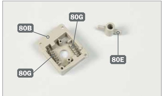
**2** ► Beide Federn 80G sind korrekt in die Leitradaufhängung 80B eingesetzt. Legen Sie die Nabe 80E bereit.
