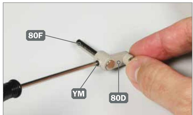
**6** ► Fixieren Sie die Leitradachse 80F am Achsschenkel 80D, indem Sie die Schraube YM eindrehen.
