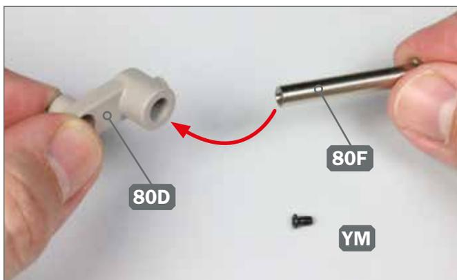
**5** ► Legen Sie eine Schraube YM bereit. Fügen Sie die Leitradachse 80F in die Bohrung des Achsschenkels 80D ein, wie es der Pfeil andeutet.
