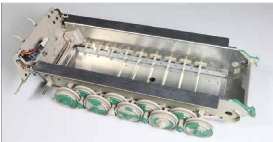
▶ Die zweite Leitradaufhängung ist zusammengebaut und mit der ersten über eine Achse verbunden. Die Baugruppe wurde in der Panzerwanne montiert, die Achsschenkel der beiden Leiträder sind ebenfalls am Modell angebracht.
