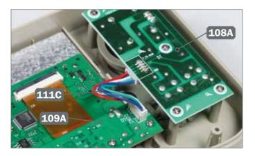
Der eine Stecker vom Kabel 111C ist mit dem Port der Platine 109A verbunden, der andere wird in den seitlichen Port der Platine 108A eingesetzt.
