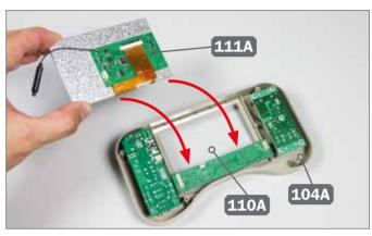
2 ► Legen Sie die Vorderseite der Fernbedienung 104A bereit. Drehen Sie den LCD-Bildschirm 111A um und setzen Sie seine Unterkante auf das untere Ende des Fensters 110A, wie es die Pfeile andeuten.
