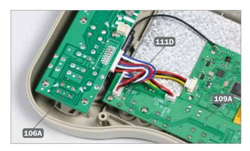
7 ► Nehmen Sie das Kabel 111D. Fügen Sie dessen zwei Stecker in die Ports der Platinen 106A und 109A ein.
