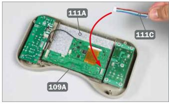
♣ Der LCD-Bildschirm 111A ist vollständig eingesetzt. Fügen Sie einen Stecker vom Kabel 111C in den Port der Platine 109A ein, auf den der Pfeil weist.
