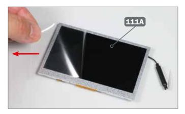
**1** ► Entfernen Sie vorsichtig die Schutzfolie von dem LCD-Bildschirm 111A, wie angedeutet.
