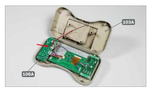
S Führen Sie die Rückseite der Fernbedienung 103A heran. Verbinden Sie dessen Stecker mit dem Port der Platine 106A (Pfeil). Drücken Sie anschließend Vorder- und Rückseite zusammen, wie im Detailbild gezeigt.
