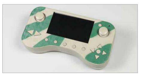
▶ Der LCD-Bildschirm ist in die Fernbedienung eingefügt, vier Kabel sind angeschlossen. Die beiden Hälften der Fernbedienung sind zusammengesetzt.
