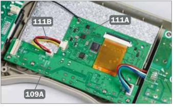
Nehmen Sie das Kabel 111B und verbinden Sie dessen zwei Stecker mit den Ports der Platinen 109A und 111A, wie abgebildet.
