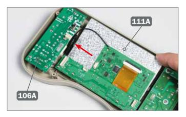
3 ► Verstauen Sie den Empfänger von 111A im Hohlraum unter der Platine 106A (Pfeil) und führen Sie die Oberkante vom Bildschirm langsam zum Fenster.
