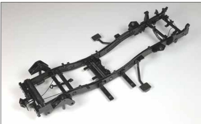
Weitere Details des Leiterrahmens wurden montiert: zwei mit Anschlüssen versehene Hydraulikschläuche, der Bremsdruckverteiler, der Zwischenhebel der Handbremse sowie eine Querverstärkung.
