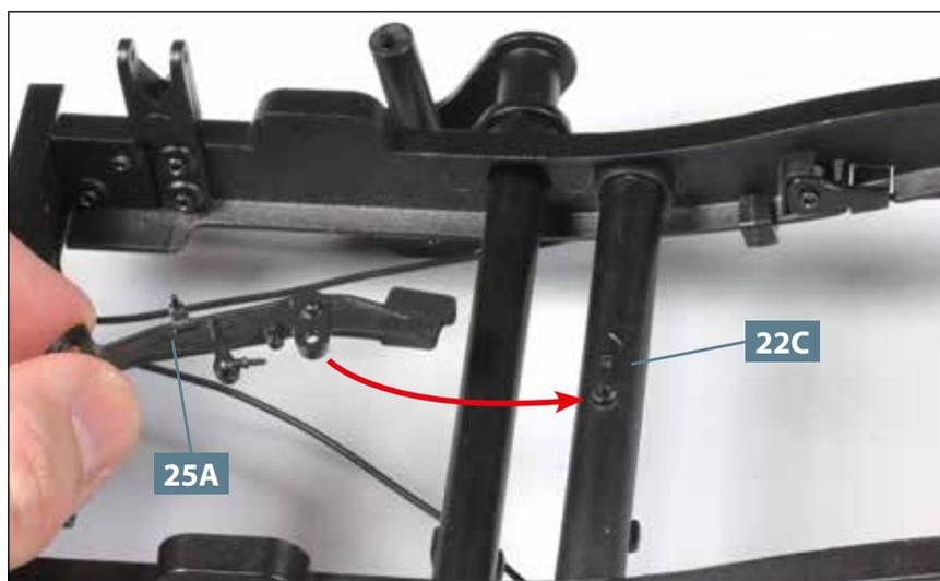
**02** Stellen Sie den Leiterraum vorsichtig auf den Kopf. Nehmen Sie den Zwischenhebel der Handbremse **25A** und führen Sie seine Lasche zur Bohrung im fünften Querträger **22C**, wie angedeutet.
