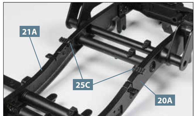
**04** Die letzten beiden Schlauchführungen **25C** gehören etwas weiter hinten an die beiden Längsträger **20A** und **21A**, wie abgebildet.
