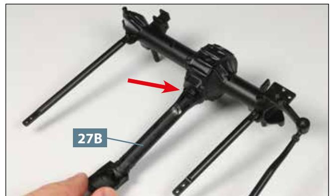
**06** Nehmen Sie das Oberteil des Schubrohrs **27B** und haken Sie dessen vorderes Ende hinter den Flansch an der Rückseite der Vorderachse. Der Pfeil weist auf die Stelle.
