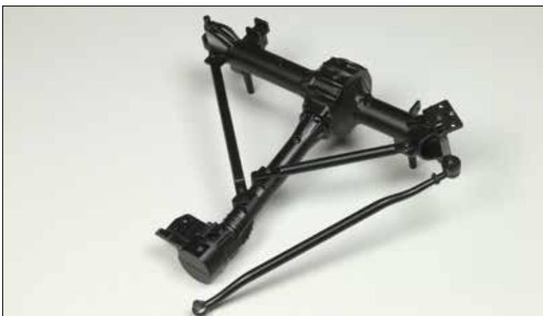
Die Vorderachse hat ihre obere Hälfte erhalten. Das Schubrohr wurde an ihr befestigt. Die beiden Achsstreben sind mit dem Schubrohr verbunden.
