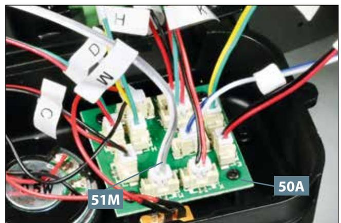
**08** Als Letztes wird der Stecker vom Kabel mit den Deckenlichtschaltern **51M** (mit der Kabelmarkierung M) mit dem Port M der Platine **50A** verbunden.
