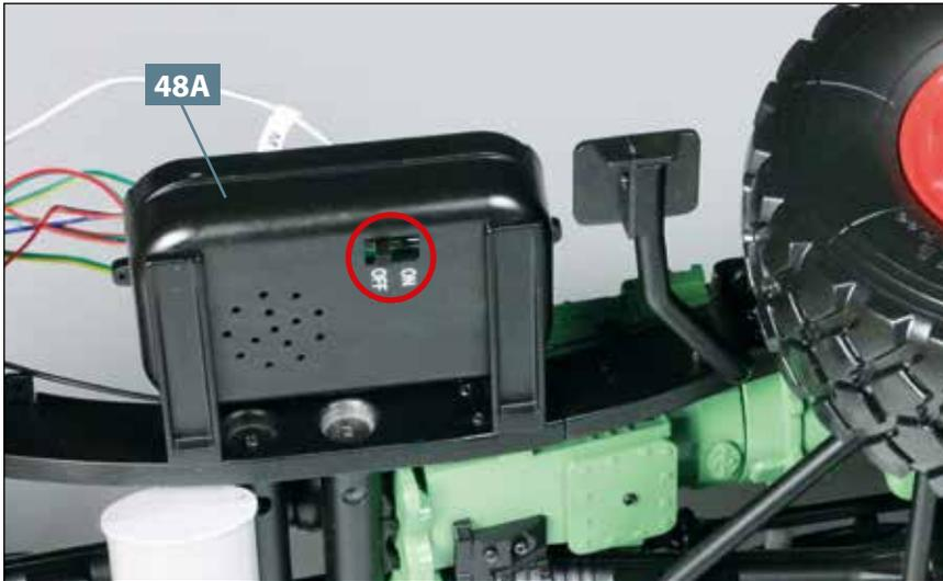
**17** Nachdem Sie alle beschriebenen Funktionstests der Elektronik durchgeführt haben, stellen Sie den Hauptschalter am Batteriefach **48A** auf „OFF“ (eingekreist).
