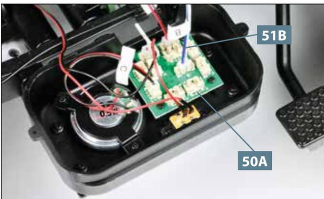
**01** Nehmen Sie das Kabel mit dem Bremslichtschalter **51B** (mit der Kabelmarkierung B) und fügen Sie dessen Stecker in den Port B der Platine **50A** ein, wie es das Foto zeigt.
