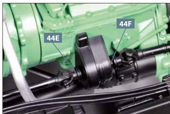
**16** Der vordere und der hintere Nebenabtrieb sind miteinander verbunden: Der Zapfen des Anschlusses **44F** sitzt in der Aufnahme des Anschlusses **44E**.
