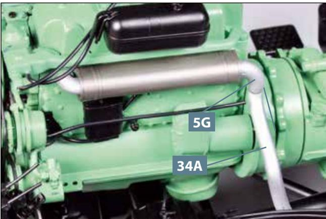
**09** Wechsel auf die linke Motorseite: Fügen Sie den Zapfen vom Auspuffrohr **34A** von unten in die Bohrung vom Auspuffkrümmer **5G** ein, wie abgebildet.
