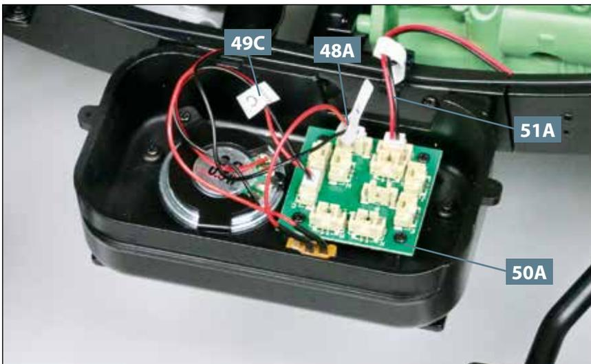
**18** Entfernen Sie die Stecker der folgenden Kabel wieder aus den Ports der Platine **50A**: **51B**, **51D**, **51E**, **51G**, **51H**, **51J**, **51K** und **51M**.
