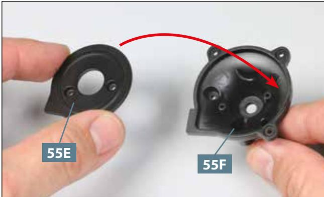
**01** Nehmen Sie das Deckelinnenteil **55E** und setzen Sie es in den Windendeckel **55F** ein, wie angedeutet.
