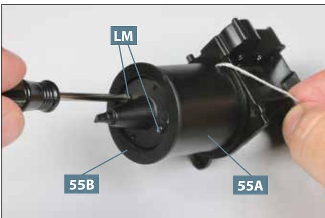
**09** Befestigen Sie den Trommeldeckel **55B** an der Seiltrommel **55A**, indem Sie die beiden Schrauben **LM** eindrehen, wie abgebildet.
