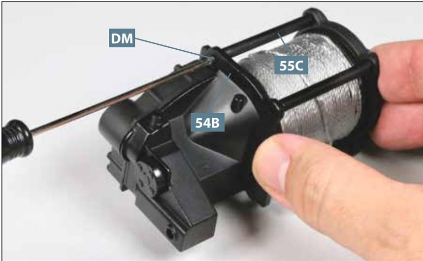
**16** Drehen Sie die Baugruppe um und befestigen Sie eins der Abstandsrohre **55C** nun mit einer Schraube **DM** am Gehäuse **54B**, wie es das Foto zeigt.
