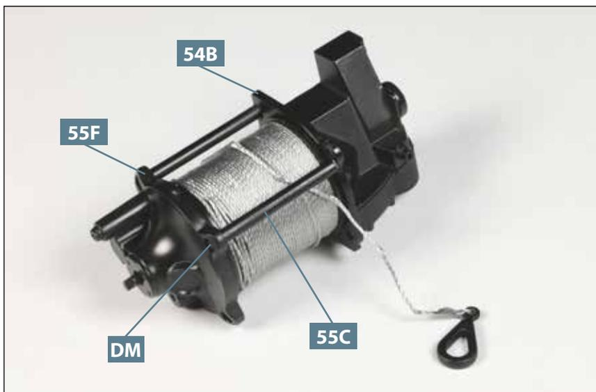
**14** Das zweite Abstandsrohr **55C** wird in die benachbarten Aufnahmen am Windendeckel **55F** und am Gehäuse **54B** eingefügt. Achten Sie auch hier auf die Ausrichtung des Rohrs und befestigen Sie es mit einer Schraube **DM** am Teil **55F**.
