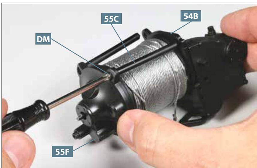
**15** Zuletzt ist das dritte Abstandsrohr **55C** an der Reihe: Es wird zwischen Windendeckel **55F** und Gehäuse **54B** platziert und mit einer Schraube **DM** am Teil **55F** fixiert. Achten Sie auch hier auf die Ausrichtung des Rohrs.
