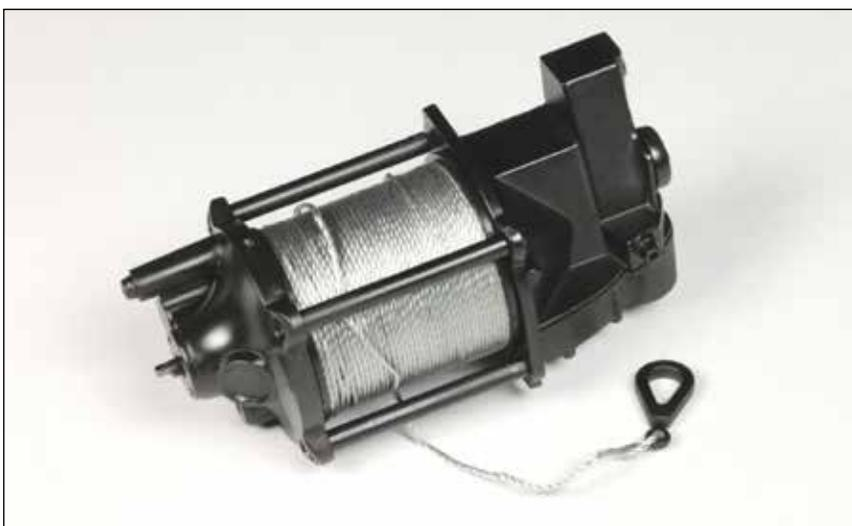
Die Seilwinde nimmt Gestalt an: Unter anderem wurden die Seiltrommel, das Seil und der Windendeckel montiert.
