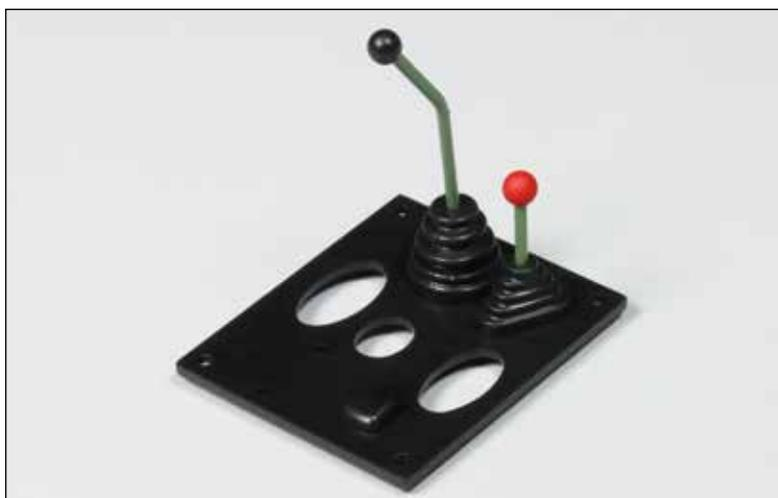
Die ersten beiden Elemente sind an der Schalthebelabdeckung befestigt: der Gangschalthebel und der Gruppenwahlhebel.
