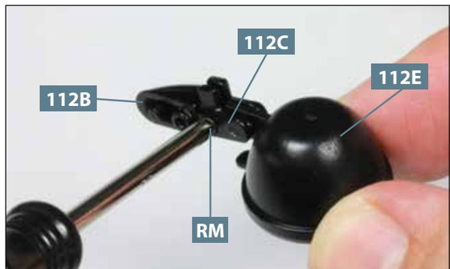
**06** Nun entsteht der linke Scheinwerfer: Den Arm des Reflektors **112E** in die Halterung **112B** einfügen, die Abdeckung **112C** aufsetzen und mit einer Schraube **RM** fixieren.
