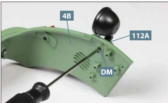
**09** Fixieren Sie den rechten Frontscheinwerfer **112A** an der Beplankung **4B**, indem Sie von innen eine Schraube **DM** eindrehen, wie abgebildet.
