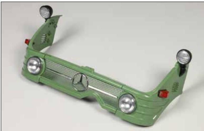
Die beiden Frontscheinwerfer sind zusammengefügt und an der Front-Baugruppe befestigt.
