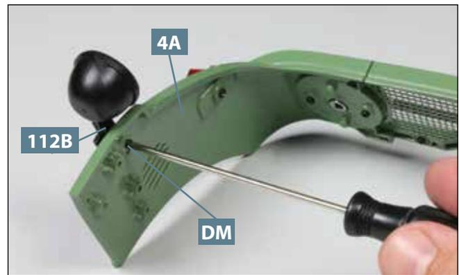
**10** Positionieren Sie den linken Frontscheinwerfer **112B** außen auf der linken Beplankung **4A** und fixieren Sie ihn von innen mit einer Schraube **DM**.
