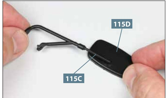
**02** Der abgewinkelte Zapfen am anderen Ende des Endstücks **115C** wird in die Aufnahme an der Rückseite des Seitenspiegels **115D** eingefügt.
