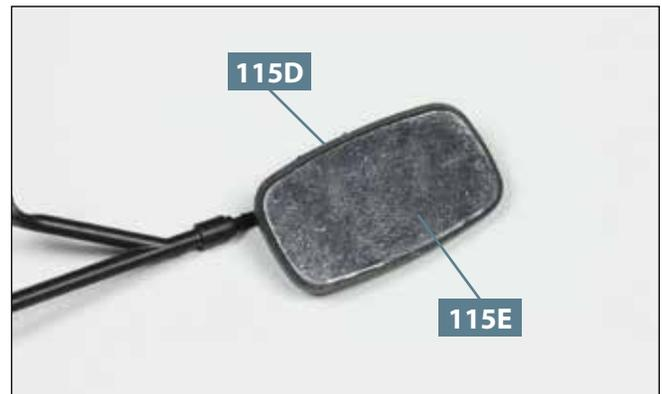
**04** Drehen Sie die Seitenspiegel-Baugruppe um und kleben Sie das Spiegelglas **115E** auf dem Seitenspiegel **115D** fest, wie abgebildet.
