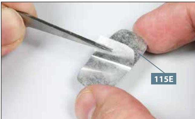
**03** Lösen Sie die Trägerfolie von dem Spiegelglas **115E**.
