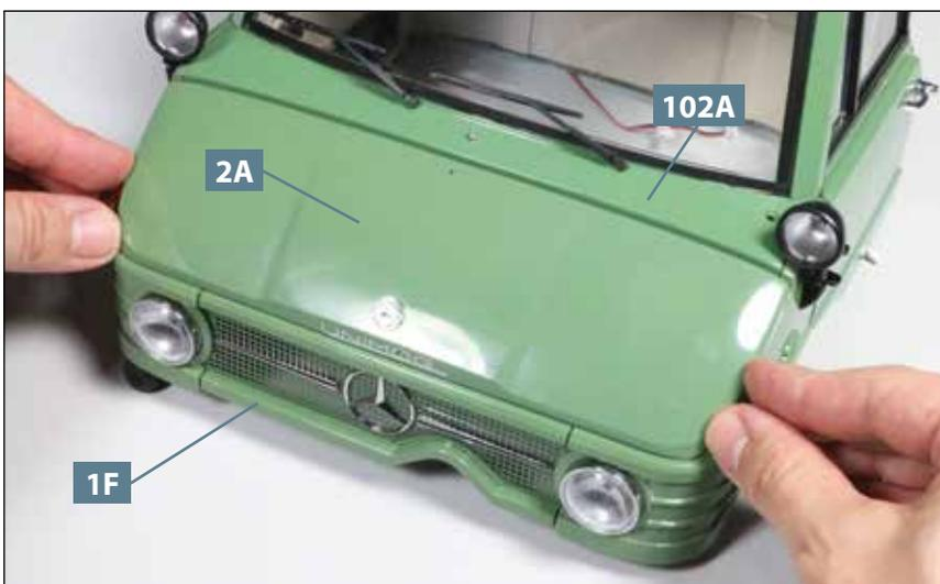
**01** Nehmen Sie die Motorhaube **2A** und fügen Sie sie in die Aussparung zwischen der Frontplatte **1F** und dem Fahrerhaus **102A** ein, wie abgebildet.
