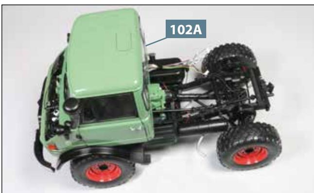
**03** Setzen Sie das Fahrerhaus **102A** auf das Chassis. Sehen Sie sich unbedingt sämtliche folgende Bauschritte an, bevor Sie mit dem Zusammenbau fortfahren. Nehmen Sie die Haubenstütze **113G** aus dem Motorraum heraus.
