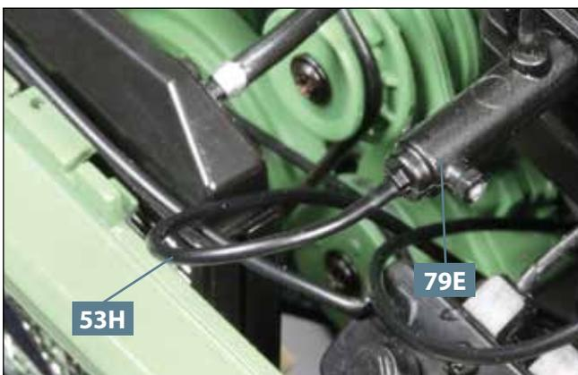
**11** Das freie Ende des Handbremsseils **53H** wird am Zapfen befestigt, der sich vorne am Hauptzylinder des Bremsverstärkers **79E** befindet.
