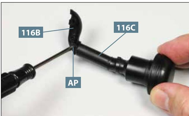
**05** Am unteren Ende des Ansaugkamins **116C** setzen Sie die rechte Hälfte vom Fuß **116B** auf. Fixieren Sie sie mit einer Schraube **AP**.
