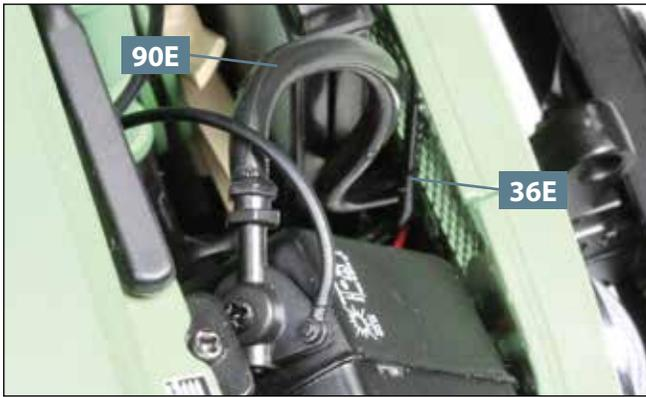
**13** Das untere Ende des Hydraulikschlauchs **90E** wird am seitlichen Zapfen der Schlauchleitung **36E** befestigt.
