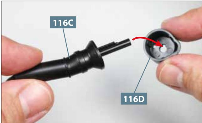
**01** Nehmen Sie den Ansaugkamin **116C** und fügen Sie den Zapfen an dessen oberem Ende in die Bohrung des Unterteils vom Zyklon-Vorabscheider **116D** ein, wie angedeutet.
