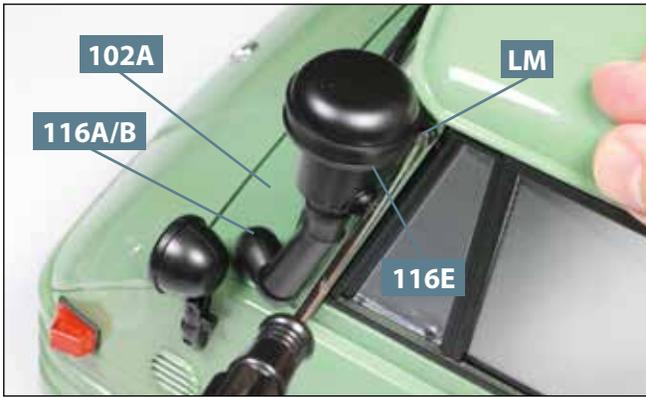
**07** Platzieren Sie den Fuß des Ansaugkamins **116A/B** in der Bohrung des Fahrerhauses **102A**. Fixieren Sie den Kamin, indem Sie die Lasche von **116E** mit einer Schraube **LM** am Fahrerhaus befestigen.
