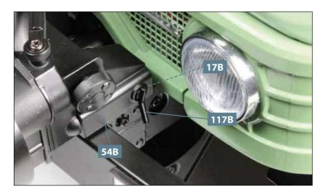
**04** Platzieren Sie die Seilwinde auf der Stoßstange **1E** (Detailbild). Links wird die Seilwinde befestigt, indem Sie den Sicherungsbolzen **117B** durch die Bohrung des Windengehäuses **54B** in die Aufnahme der linken Windenhalterung **17B** einfügen.
