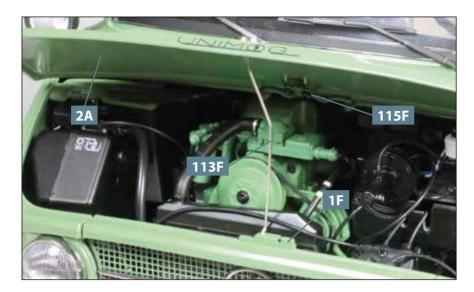
Befestigen Sie die Motorhaube **2A** wieder am Modell, indem Sie die Halterung **115F** unter den beiden Aufnahmen einfügen (siehe hierzu auch Bauanleitung 115, Schritt 3.02). Testen Sie die Funktion der Motorhaubenstütze **113F**, indem Sie ihre Enden in die Aufnahmen an der Motorhaube und der Frontplatte **1F** einfügen, wie abgebildet.
