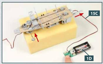
Verbinden Sie das Kabel des Motors **15C** mit dem Port "M2" der Testplatine **1D**. Drücken Sie den äußeren Knopf der Platine, um die Anker einzuholen, wie es die Pfeile andeuten (siehe hierzu auch Schritt 2/2!). Bei Druck auf den anderen Knopf werden die Anker fallen gelassen.
