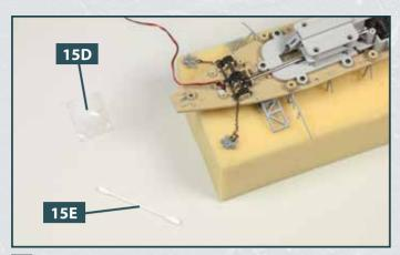
Positionieren Sie die umgedrehte Unterdecks-Baugruppe auf einer sicheren Unterlage. Legen Sie das Schmierfett **15D** und das Wattestäbchen **15E** bereit.
