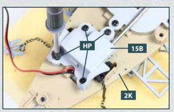
4 Befestigen Sie das vordere Getriebegehäuse **15B** am Unterdecksabschnitt **2K**, indem Sie vier Schrauben **HP** eindrehen.
