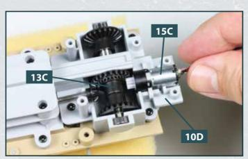
Nehmen Sie den Motor **15C** und setzen Sie ihn in das Motorund Getriebegehäuse **10D** ein. Die Nabe des Motors greift in das Zahnrad **13C**, wie abgebildet.
