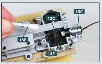
6 Verteilen Sie mithilfe des Wattestäbchens 15E Schmierfett auf der Nabe des Motors 15C, auf dem Zahnrad 13C sowie auf dem Kegelrad 14F.
