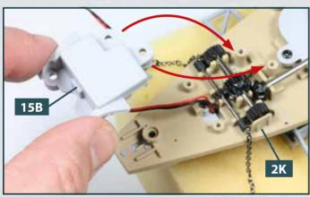
Nehmen Sie das vordere Getriebegehäuse **15B** zur Hand und setzen Sie es auf die Aufnahmen des Unterdecksabschnitts**2K**, wie es die Pfeile andeuten.
