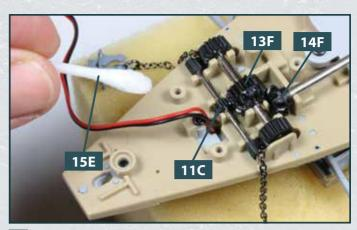
Nehmen Sie mit dem Wattestäbchen 15E etwas Schmierfett auf und verteilen Sie dieses großzügig auf den Zahnrädern der Wellen 11C und 13F sowie auf dem Kegelrad 14F.
