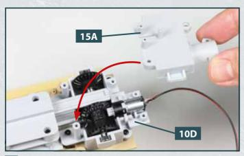
7 Nun wird das Unterteil vom Motorgehäuse **15A** auf das Oberteil **10D** gesetzt, wie es der Pfeil andeutet.
