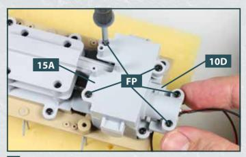
8 Fixieren Sie das Motorgehäuse **15A** mit fünf Schrauben **FP** am Motorgehäuse **10D**.
