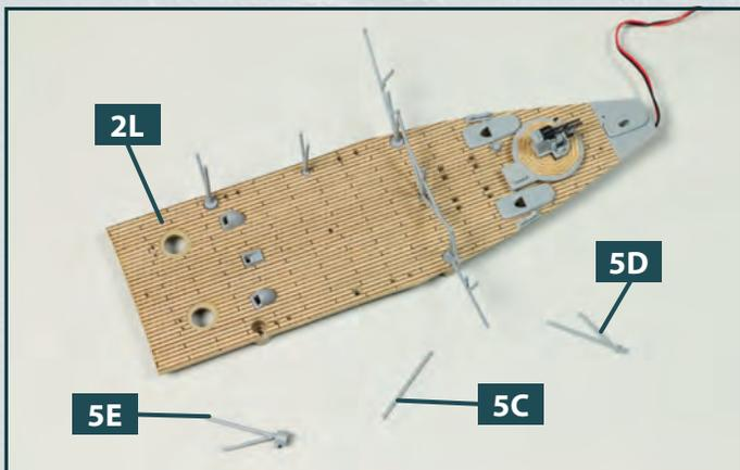
**1** Legen Sie den Unterdeckabschnitt **2L** sowie die drei Tragstreben-Bauteile **5C**, **5D** und **5E** auf Ihre Arbeitsplatte.
